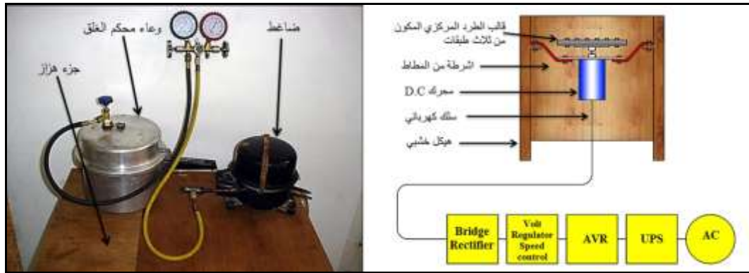
الشكل (3): المخطط العام لمنظومة السباكة الطرد
