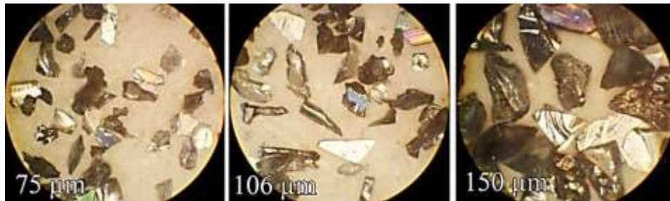
الشكل (1): دقائق كربيد السليكون المستعملة في البحث بأحجامها الثلاثة (X100).
